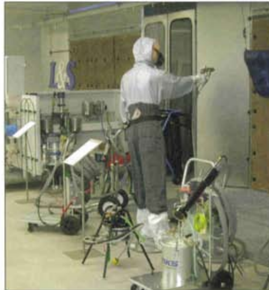
Blick auf das Technologiezentrum mit einem Lackierroboter, neuester 2K- und 3K-Dosierttechnik für die manuelle Nassapplikation und einem elektrostatischen Handstand für die Pulverbeschichtung (v.l.). Die Schulungswerkstatt befindet sich in einem weiteren Raum rechts neben der Pulverapplikation (r.).
