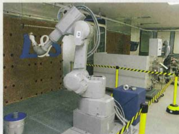
Der Technikbereich ist ausgestattet für verschiedenste Auftragsversuche von der vollautomatischen Roboter-Applikation bis hin zur manuellen Lackierung mit Nass- und Pulverlacken
