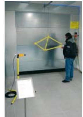
Pulverlackierstand mit Deckenförderer
