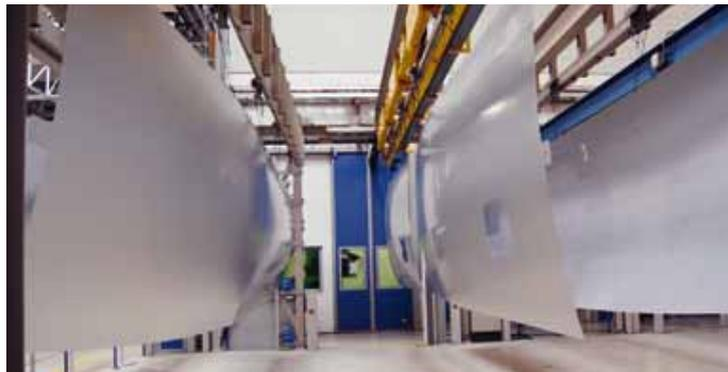
Über ein P+F-System werden die Hautfelder mit max. Abmessungen von ca. 9 m Länge und 2,2 m Höhe der Lackierkabine zugeführt, wo sie automatisiert mit Robotern lackiert werden. Quelle: Redaktion
