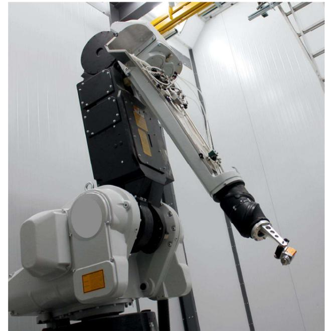
Die Mischer und Farbwechselventile sind auf dem Prozessarm der Roboter installiert. Foto: L&S
