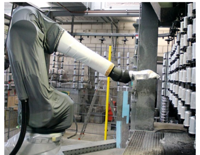
Im zweiten Schritt hat der Lohnbeschichter den Roboter am Kreisförderer erneuern lassen. Der Roboter ist mit einer luftunterstützten Hochdruck-Elektrostatik-Farbspritzpistole und einer 2K-Anlage ausgerüstet.
