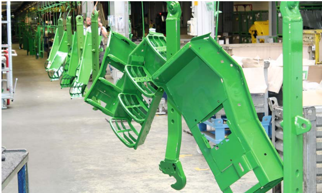
Im Mannheimer Werk werden Bauteile wie Rahmen, Getriebe oder Kleinteile nach der Zinkphosphatierung und einer Epoxy-KTL als Grundierung und abschließend decklackiert. Quelle: Redaktion
