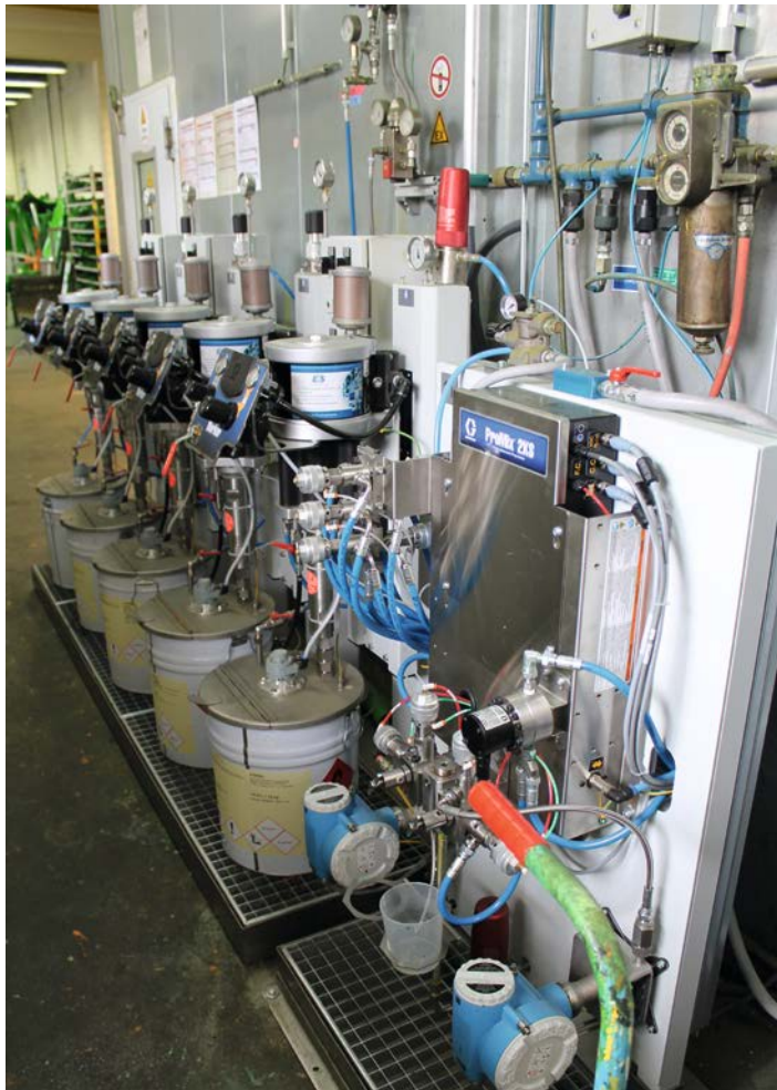
Insgesamt wurden zwölf neue 2K-Anlagen vom Typ „2KS“ von Graco installiert. Dieses Misch- und Dosiersystem ist für manuelle und automatische Anwendungen geeignet und kann bis zu 30 Farben und vier Härter verarbeiten.
