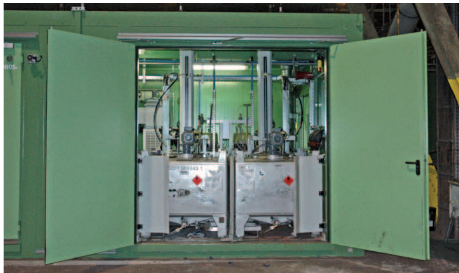
Die Farbversorgung der Grobblech-Beschichtungsanlage erfolgt über 1.000 Kilogramm Container.
