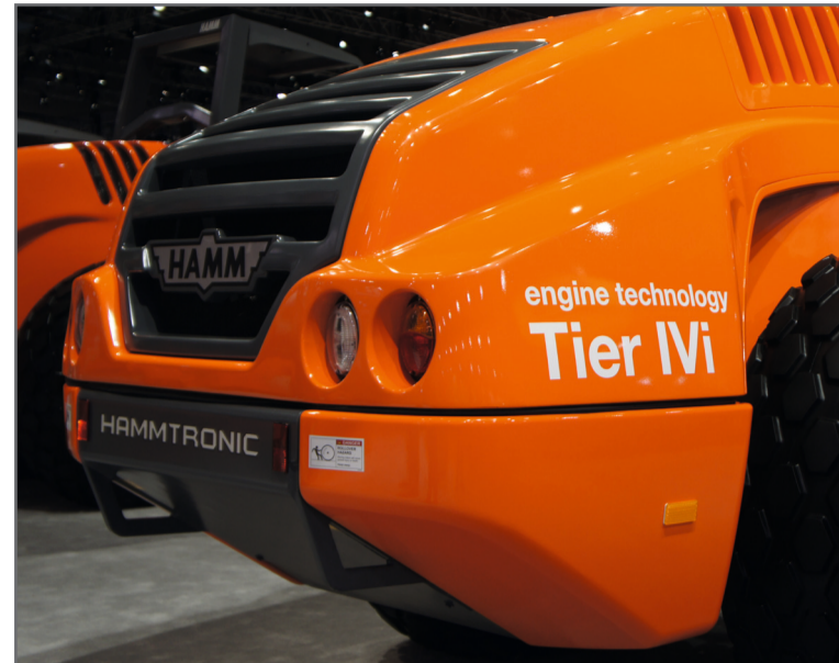
Das hier im unteren Teil verbaute Gegengewicht aus Beton ist bei Land- oder Baumaschinen fester Bestandteil des Fahrzeugs, beeinflusst die Gesamtoptik und wird daher lackiert.
