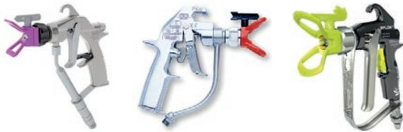
Durch die Verwendung von Drehgelenken bleiben Airless-Pistolen auch bei hohen Materialdrücken gut beweglich. Für hochgefüllte Materialien können nicht immer Pistolenfilter eingesetzt werden, da diese zu schnell zuwachsen.
