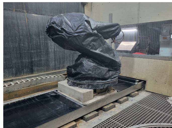
Der Roboter mit seinem speziellen Schutzmantel
