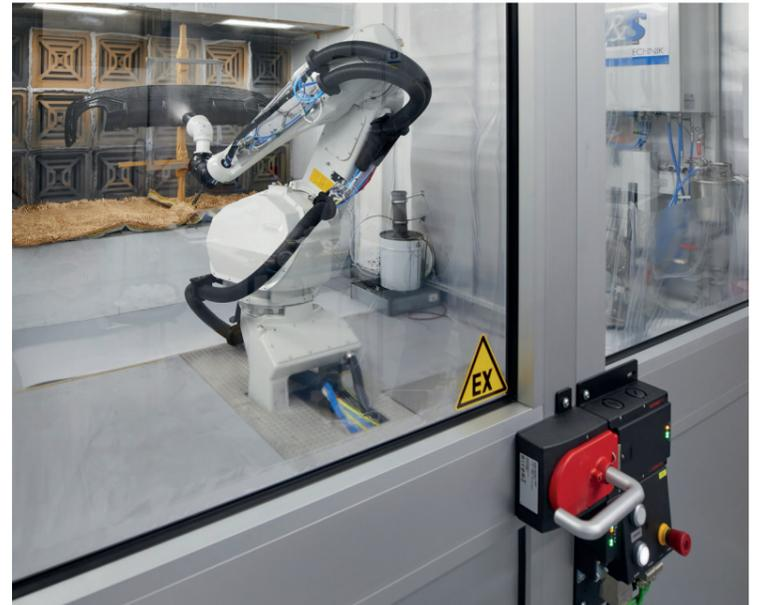
Roboter mit Hochrotationszerstäuber im Prozess
