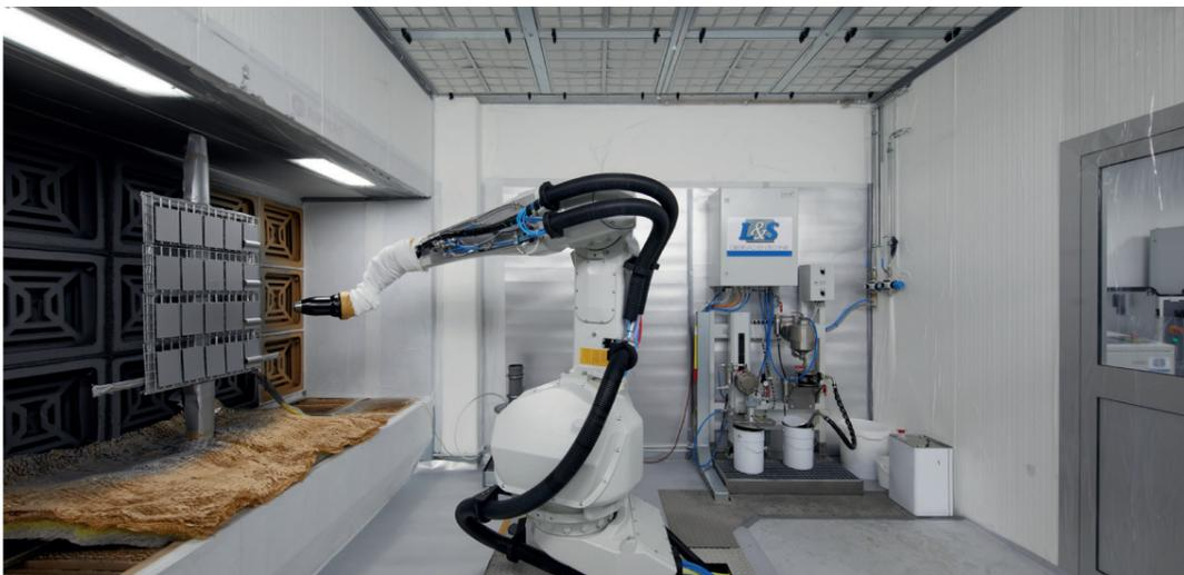
Roboter mit installiertem Hochrotationszerstäuber Typ EcoBell II. Im Hintergrund die 2K-Anlage L&S Merge Vario Robomix mit integrierter Farbversorgung
