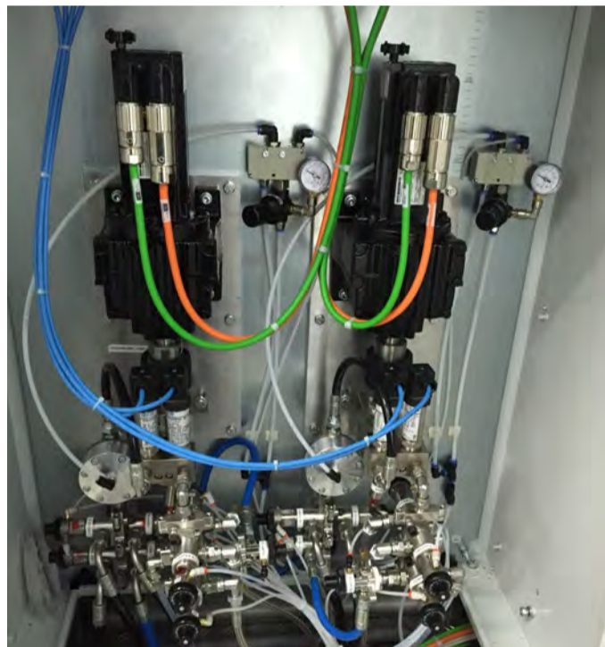
Eine mengengeregelte Anlage steuert die Mengen über die Pumpe.
