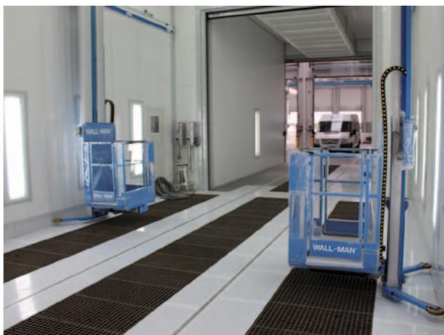
Das Oberflächenzentrum verfügt über vier Lackierkabinen, inklusive neuer Applikationstechnik. Durch die Umstellung auf die neue Applikationstechnik erzielte der Fahrzeughersteller einen reduzierten Anteil an Overspray in den Kabinen.
